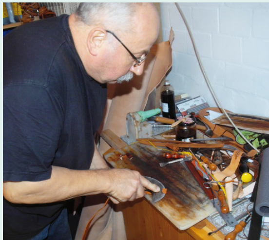
In der Peitschenwerkstatt: Axel Lackmann glättet mit einem Werkzeug namens Halbmond ein Stück Leder. Die beiden Peitschen, die er auf dem rechten Foto in der Hand hält, sind aus Nylon und mit aufwändigen Mustern versehen. Rudert (4)
